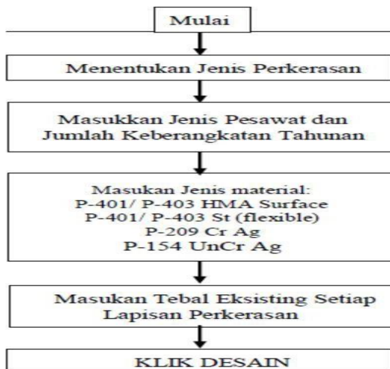
Gambar 1. Alur tahap perhitungan tebal perkerasan dengan software FAARFIELD
